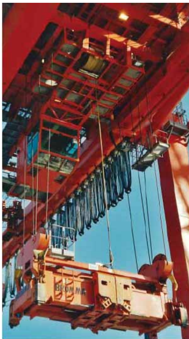
Барабан Cavotec Specimas для спредера в действии
